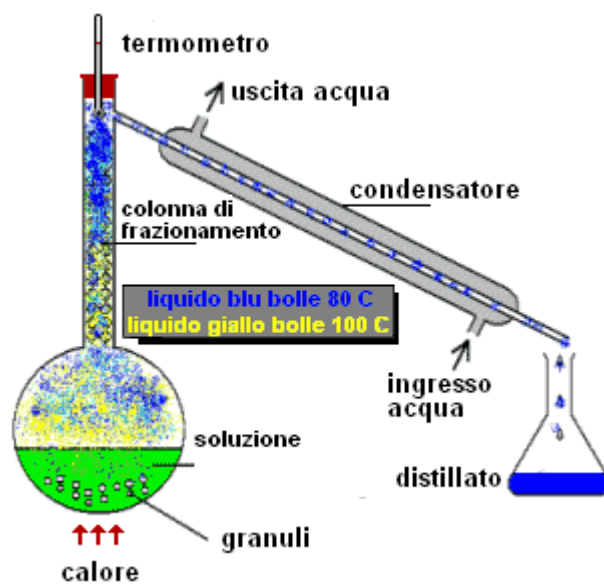
Funzionamento della distillazione frazionata
